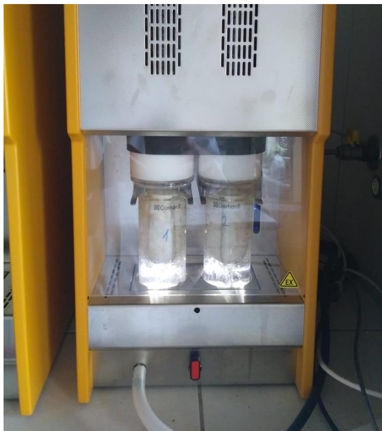
Obrázek 7: Extrakce podle Soxhleta v automatickém extraktoru
