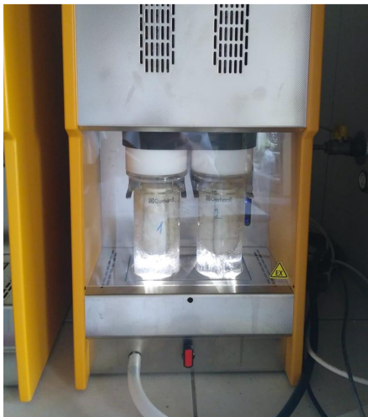
Obrázek 7: Extrakce podle Soxhleta v automatickém extraktoru
