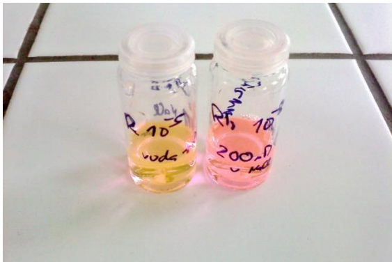
Příloha 6: Ilustrace citlivosti fluorescenční sondy rhodaminu 6G na přítomnost micel: vodný roztok soli (vlevo) a micelární vodný roztok s přítomností soli s jasným bathochromním posunem emise (vpravo)
