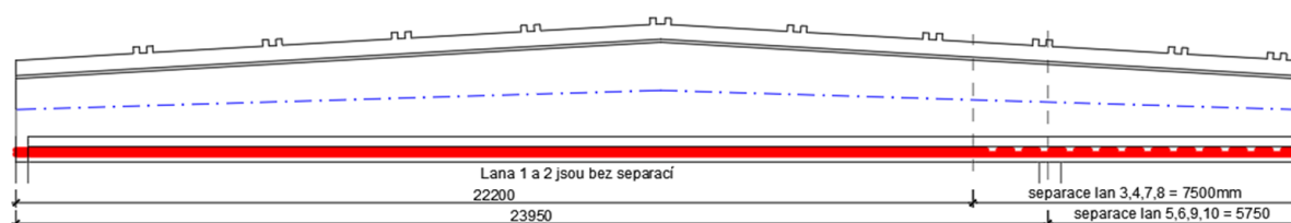
Obrázek 3 separace předpínacích lan
