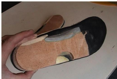
Obr. 10. Výroba vložky SZO (Suzan, 2012)
