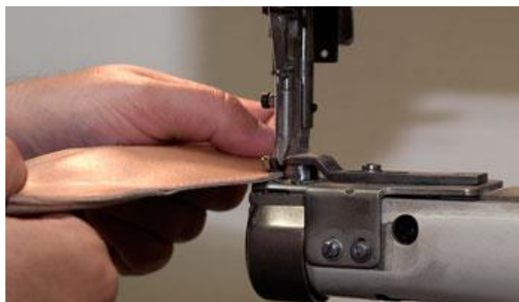
Obr. 11. Výroba vložky SZO (Suzan, 2012)
