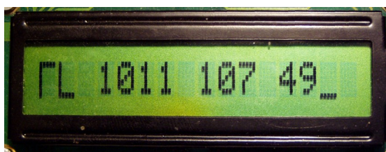
Obrázek 5.4: Ukázka detekovaného signálu (obdělák, frekvence 1011 Hz, amplituda 107 mV, střída 49%)
