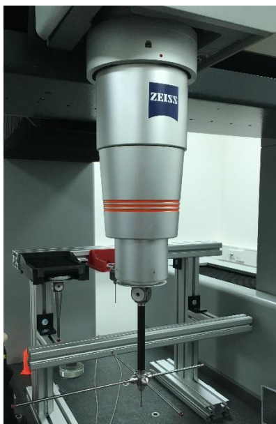
Obr. 3.6 Snímacia hlava Zeiss HSS s pripevnenou dotykovou sondou
