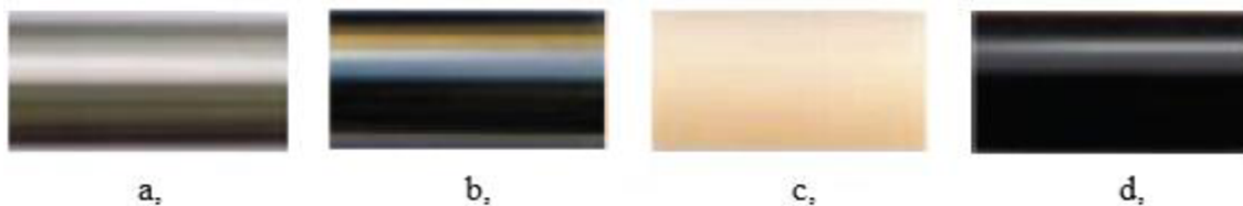
Obr. 2.10 Materiály používané pre driek dotyku: a, ocel, b, karbid volfrámu, c, keramika, d, uhlíkové vlákna [29]
