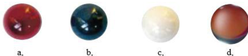
Obr. 2.9 Materiály hrotu dotyku: a, rubín, b, nitrid kremíku, c, oxid zirkoničitý, d, technický diamant [2]
