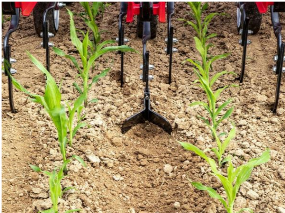
Obr. 5 Foto meziřádkové plečky s pomocnou hrůbkovací radličkou. (zdroj: Transformer VF - Chop - Hybrid Farming | HORSCH).
