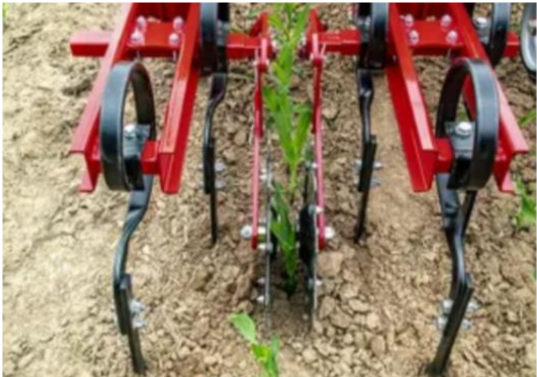
Obr. 4 Záběr meziřádkové plečky s pomocnými krojícími válci (zdroj: Transformer VF - Chop - Hybrid Farming | HORSCH).
