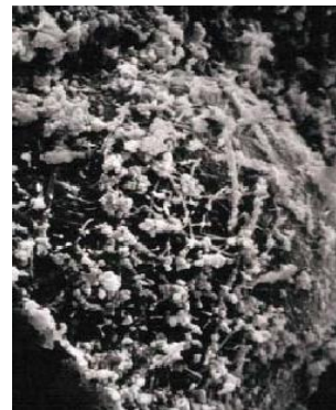
Obrázek č. 23 Částice těžkého kovu enkapsulovaná v cementové matrici ettringitem [5]
