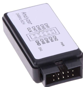
Obr. 2.6: Logický analyzátor s konektorem USB [7]
