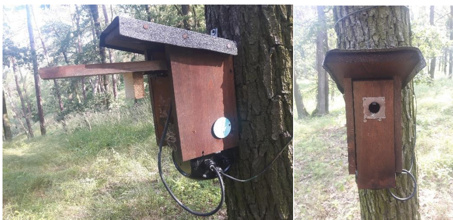
Obrázek 1. Hnízdní budka s RFID čtečkou
