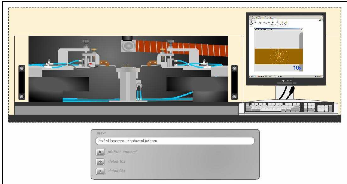
Obr. 3.14 Animace dostavování jmenovité hodnoty rezistoru LASERem
