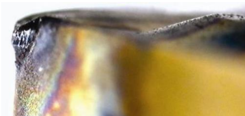
Obr. 2.12 Plastická deformace břitu [8].
