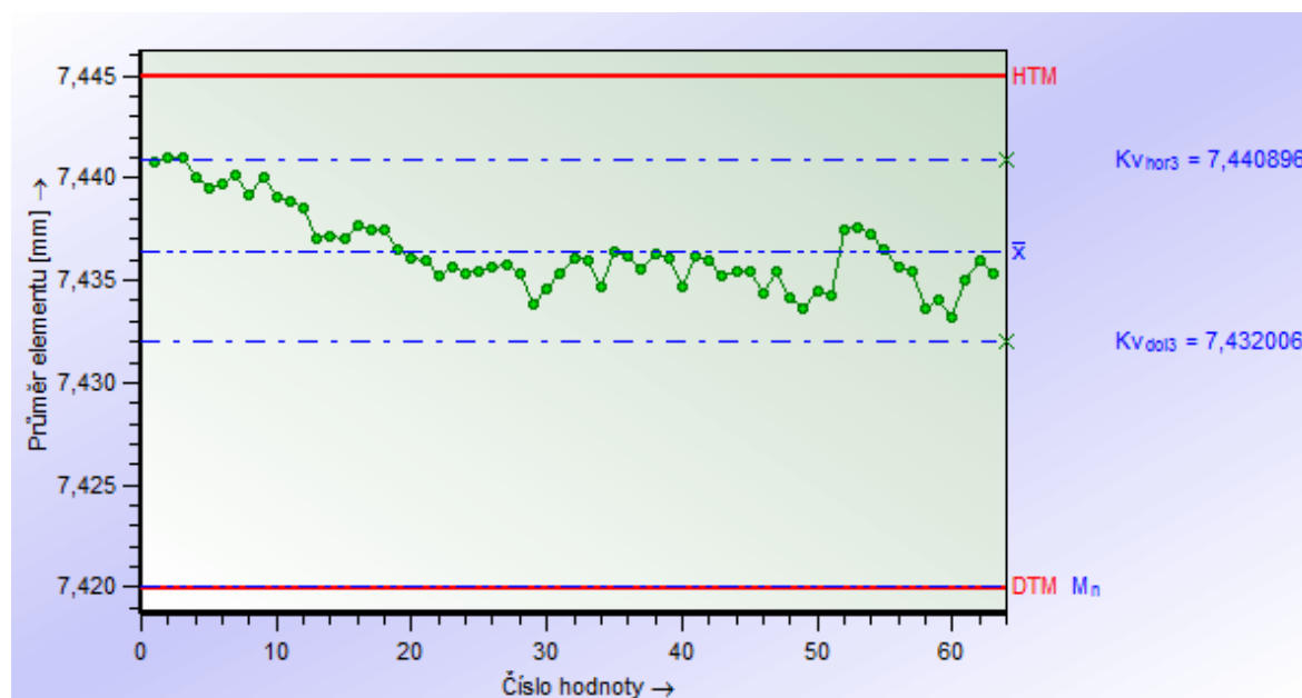
Obr. 5.24 Průměr otvoru pro píst napříč životností nástroje H1.
