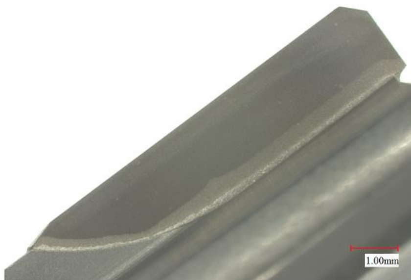
Obr. 5.5 Výstružník verze S3 – detail břitové destičky.
