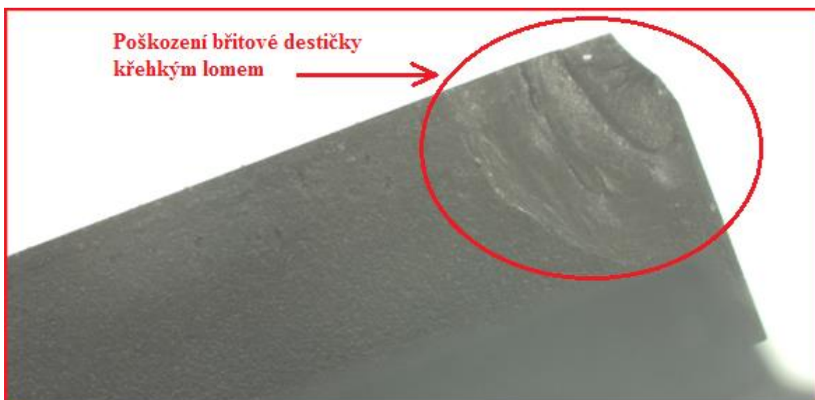
Obr. 5.18 Výstružník I2 poškozený lomem.
