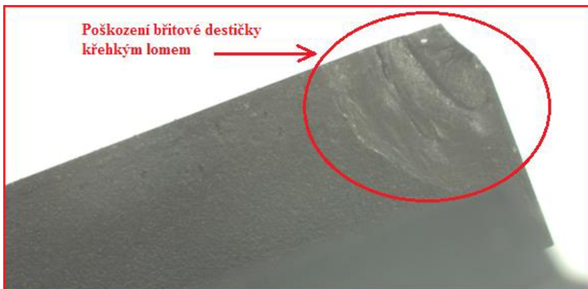
Obr. 5.18 Výstružník I2 poškozený lomem.
