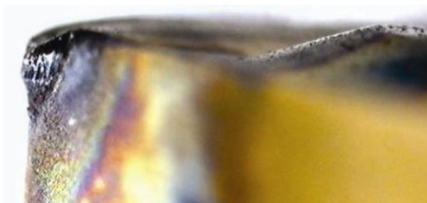
Obr. 2.12 Plastická deformace břitu [8].
