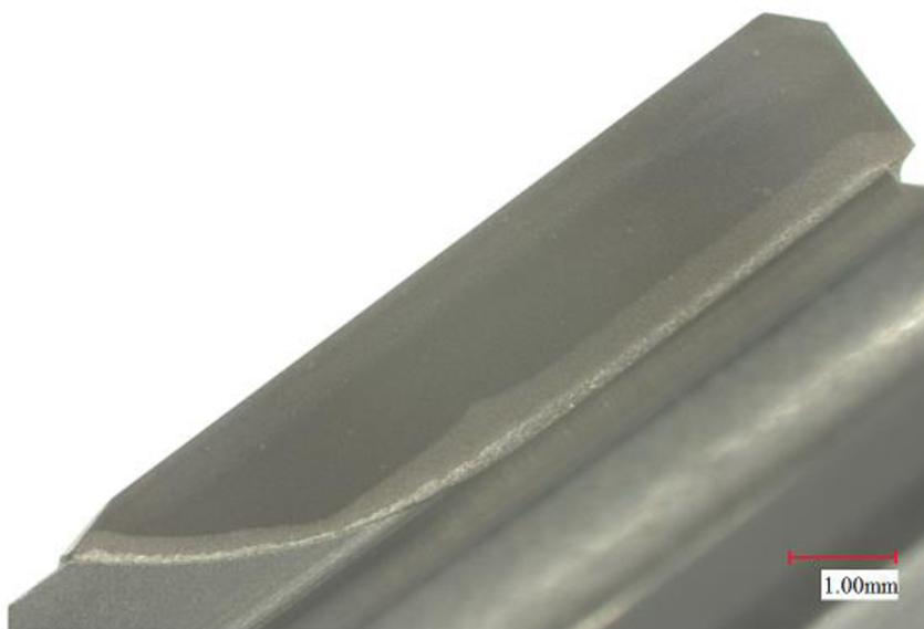
Obr. 5.5 Výstružník verze S3 – detail břitové destičky.
