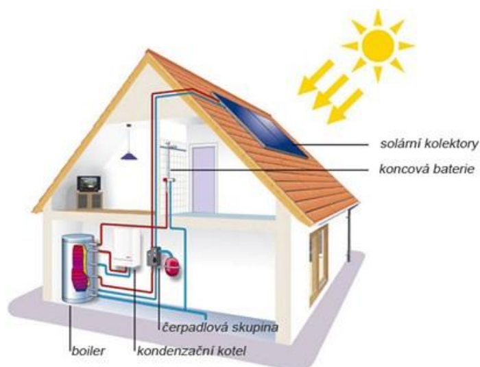
Obr. 15 Řez zapojení solárního systému [10]
