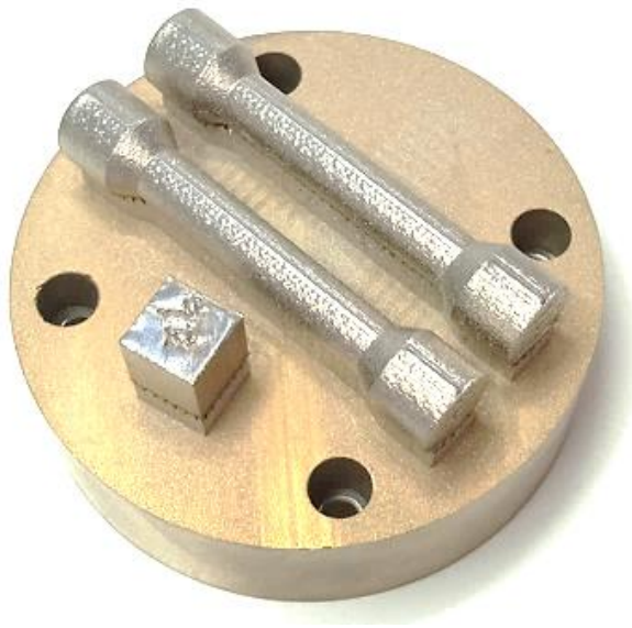
Obr. 4-11 Stavba vzorků pro tahovou zkoušku
