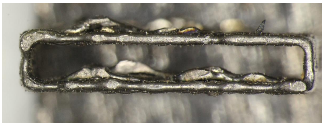
Obr. 5-4 Snímek nevhodného vzorku 3D návaru číslo 26
