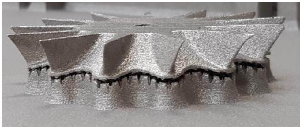
Obr. 2-1 Poškození podpůrných struktur vlivem vysokých vnitřních napětí
