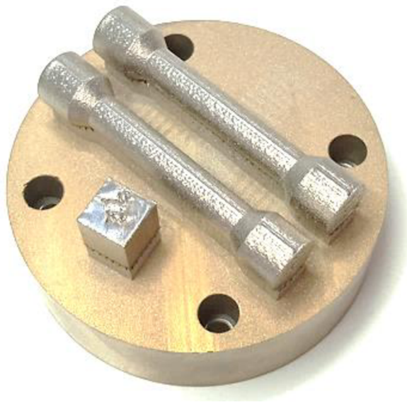
Obr. 4-11 Stavba vzorků pro tahovou zkoušku
