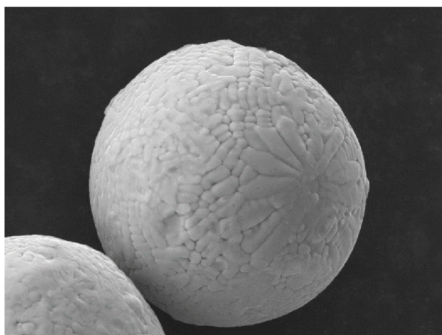
Obr. 4-12 Částice prášku IN-939 (zvětšení: 2500)
