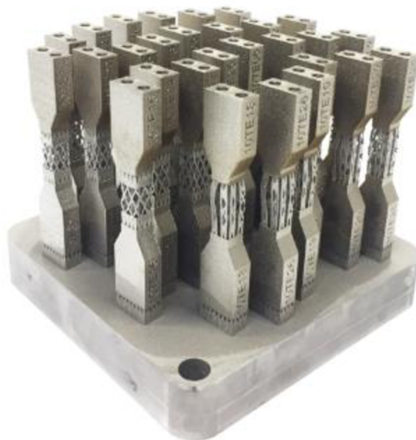
Obr. 4-9 Stavba vzorků na tahovou zkoušku s využitím různých geometrií podpůrných struktur
