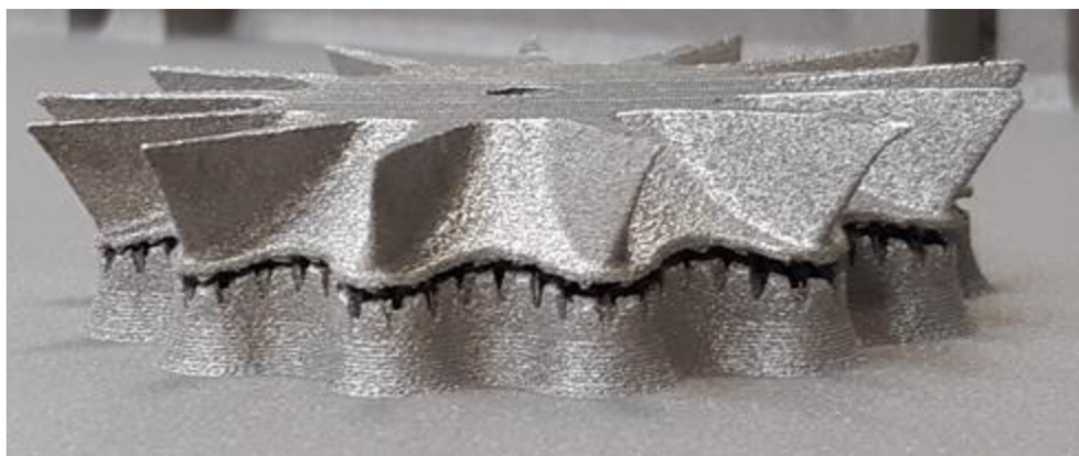
Obr. 2-1 Poškození podpůrných struktur vlivem vysokých vnitřních napětí
