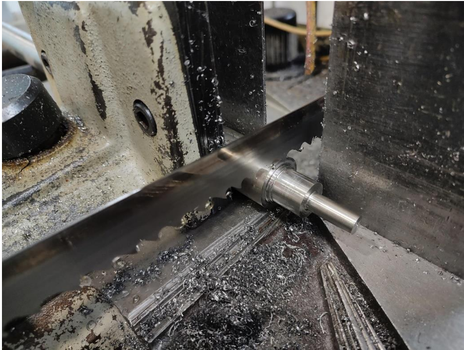
Obr. 4.11 Řezání excentru na pásové pile.
