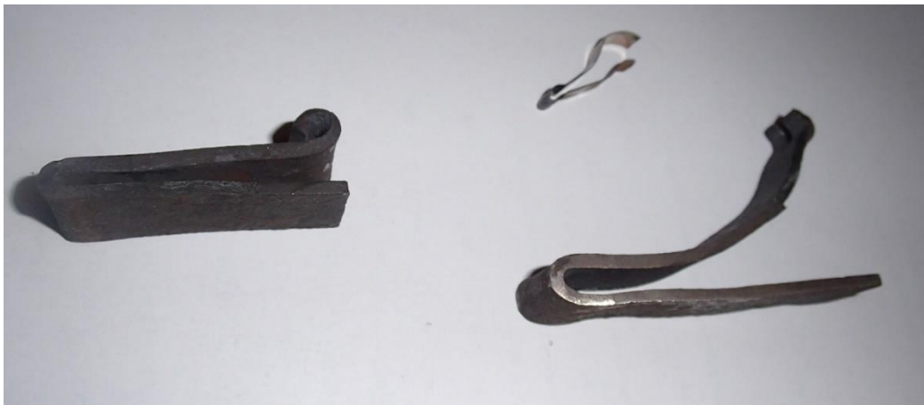
Obr. 4.29 Zakalené a popuštěné pružiny.
