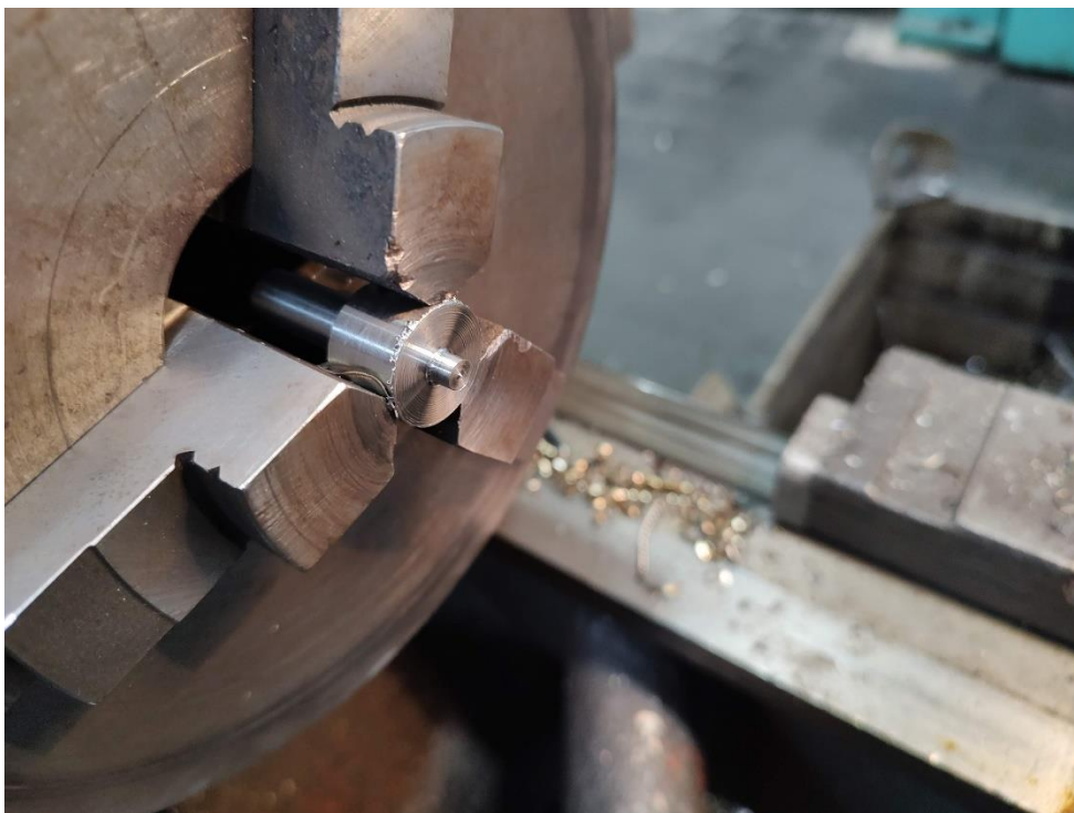
Obr. 4.12 Soustružení kratší strany excentru.
