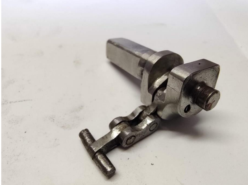
Obr. 5.1 Spojení excentru s řetězkou.
