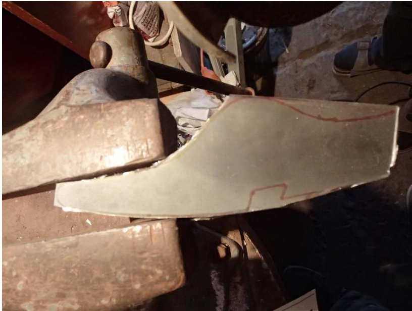
Obr. 4.1 Vytváření hrubého obrysu zámku.
