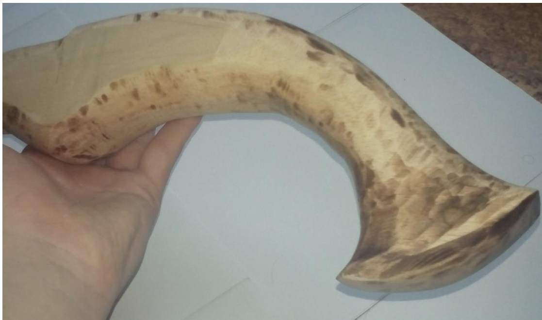
Obr. 4.33 Detail konce hlavně po hrubování.
