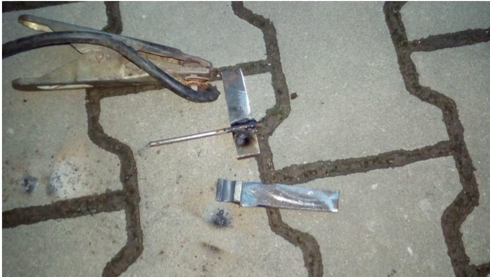
Obr. 4.28 Zhotovení nástroje pro výrobu malých rádiusů.
