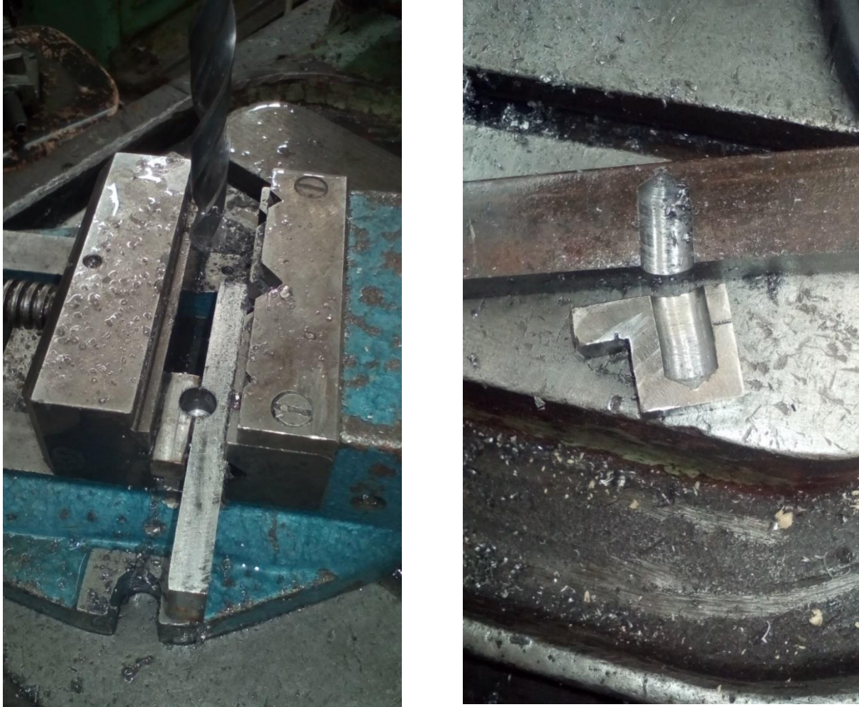
Obr. 4.26 Vyvrtávání vnitřního prostoru pánvičky.
