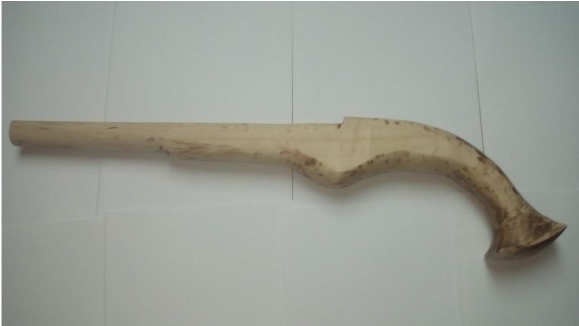
Obr. 4.32 Pažba po hrubování kotoučem na dřevo.
