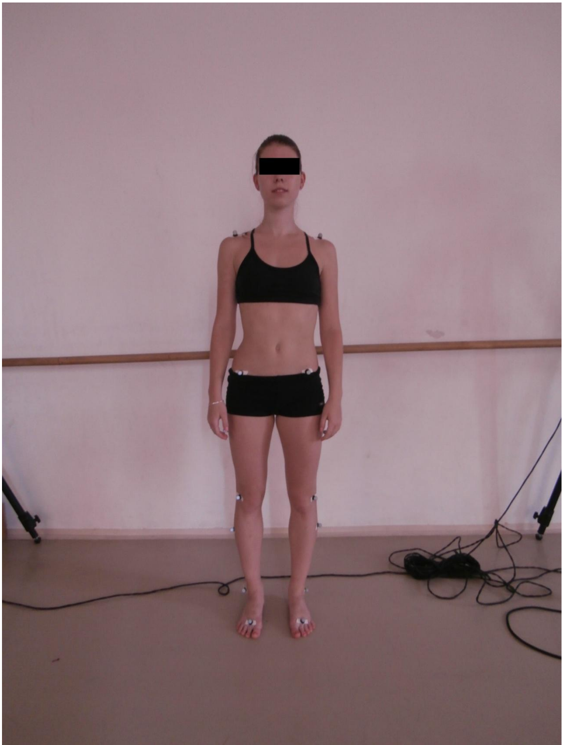
Příloha 2 Vzor uložení reflexních značek dle standardního modelu PlugInGait z ventrální strany
