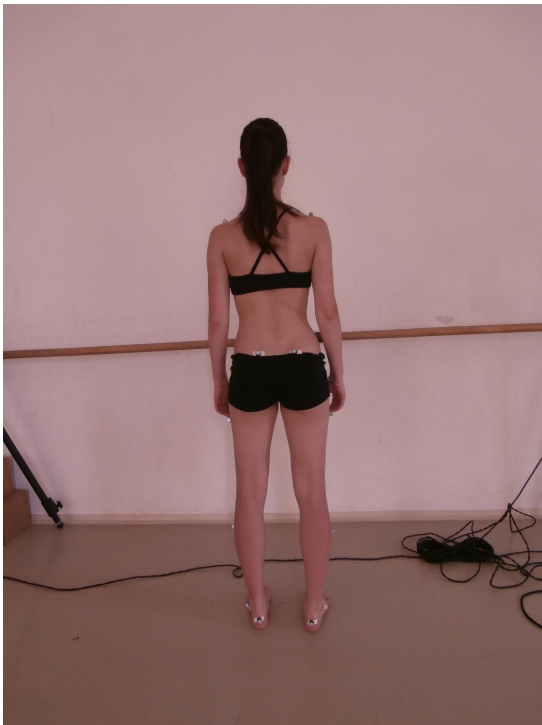
Příloha 3 Vzor uložení reflexních značek dle standardního modelu PlugInGait z dorzální strany
