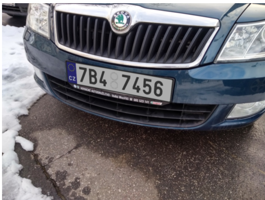
Obrázek 4.14: Obrázok, ktorý vznikol spojením syntetickej poznávej značky a fotografie automobilu na základe nájdenia homografie medzi rovinou syntetickej značky a polohou reálnej značky v rovine.
