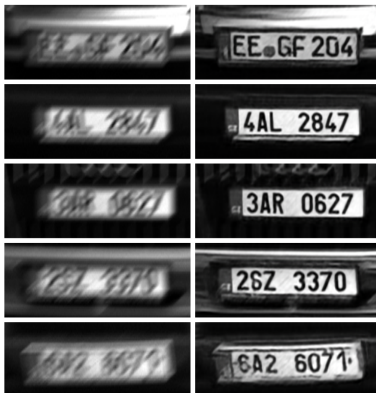
Obrázek 2.2: České ŠPZ pred a po procese reidentifikácie systémom pracujúcim s neurónovými sieťami. Prevzaté z [14].
