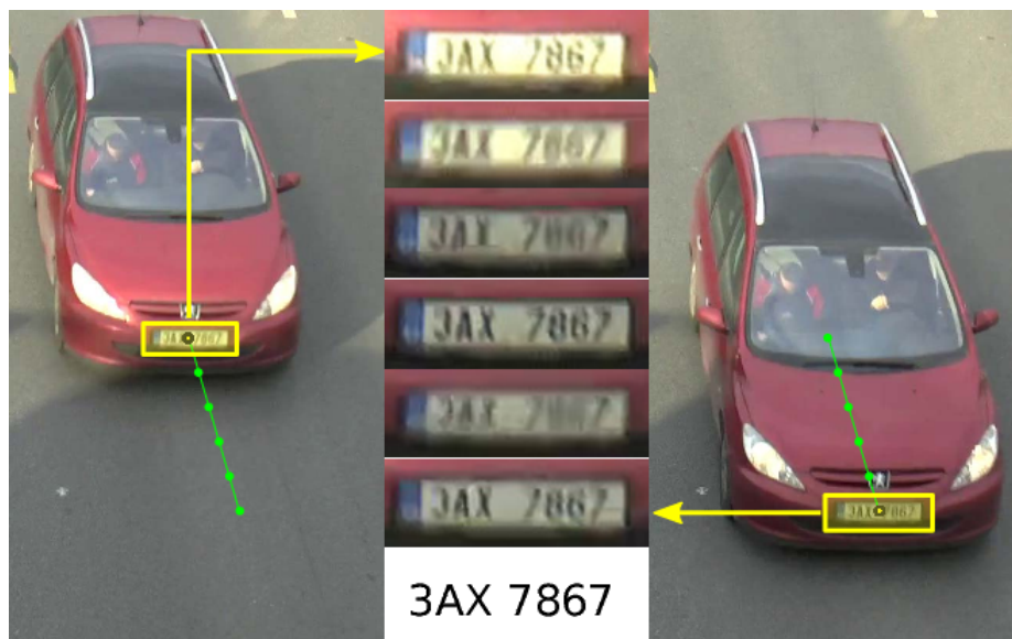
Obrázok 2.5: Ukážka holistickej metódy rozpoznávania ŠPZ. Poznávací znak je odfotený viackrát po sebe, aby sa zvýšila pravdepodobnosť zachytenia čo najlepšieho výsledku. Prevezaté z [17].
