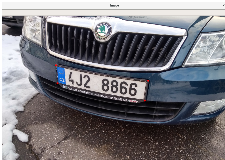
Obrázek 4.10: Na obrázku vidíme ukážku grafického rozhrania skriptu, ktorý slúži na naklikanie súradníc reprezentujúcich polohu poznávacej značky vo fotografií. Červené body na obrázku symbolizujú súradnice, ktoré boli vytvorené kliknutím ľavého tlačidla myši. Súradnice sa po ich potvrdení klávesou X uložia do textového súboru.
