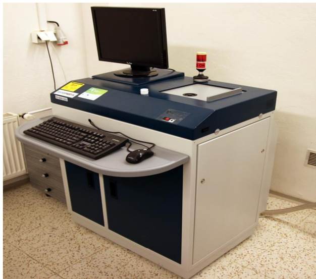
Obrázek 14: Rentgenový fluorescenční spektrometr [37]
