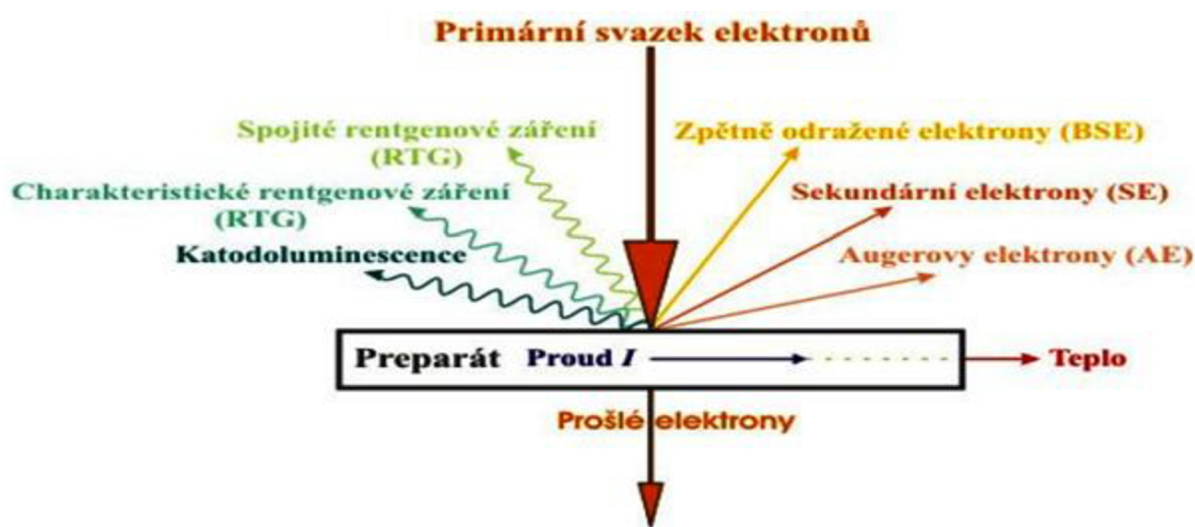
Obrázek 17: Signály vzniklé interakcí primárních elektronů s preparátem [46]
