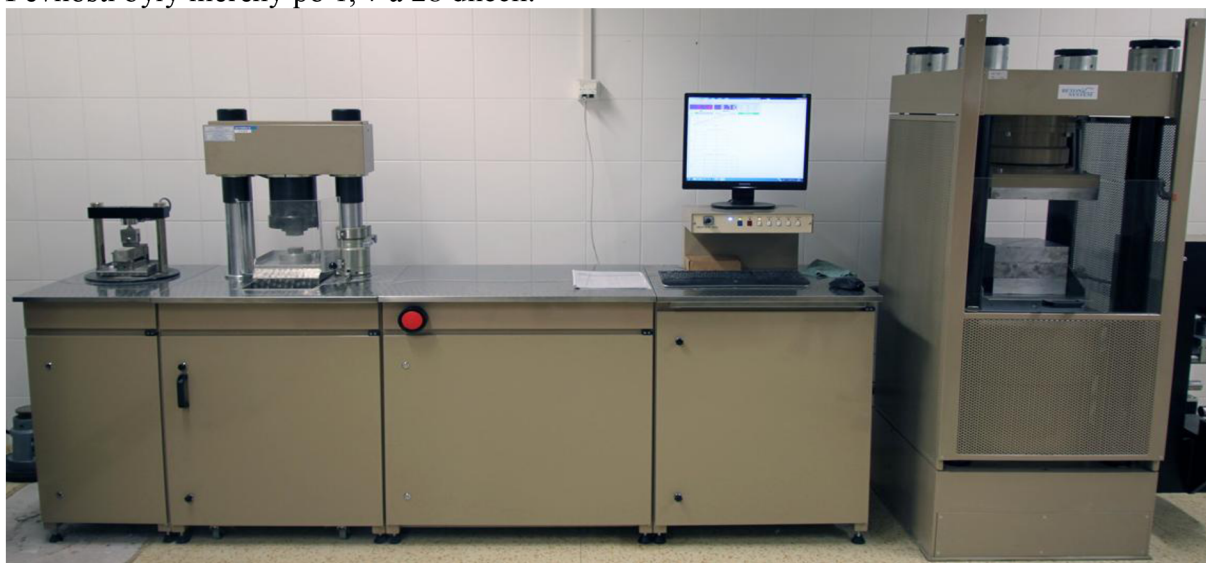
Obrázek 20:Hydraulický lis pro mechanické testování [37]
