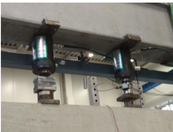
Obr. 6.57 Detail zatěžovacích lisů
