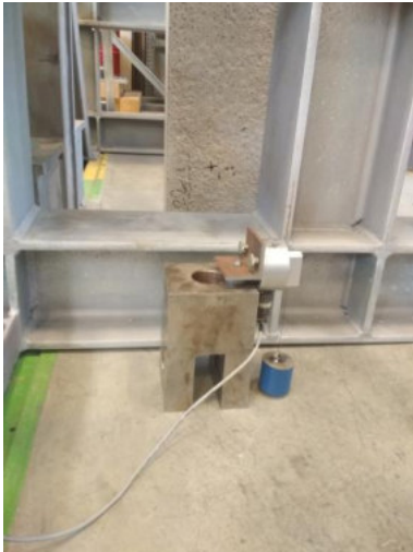
Obr. 6.134 Potenciometr v patě pilíře
