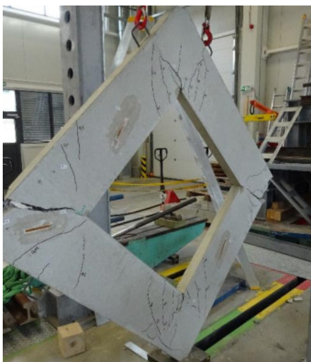
Obr. 7.23 Porušení vzorku SV4 – experiment
