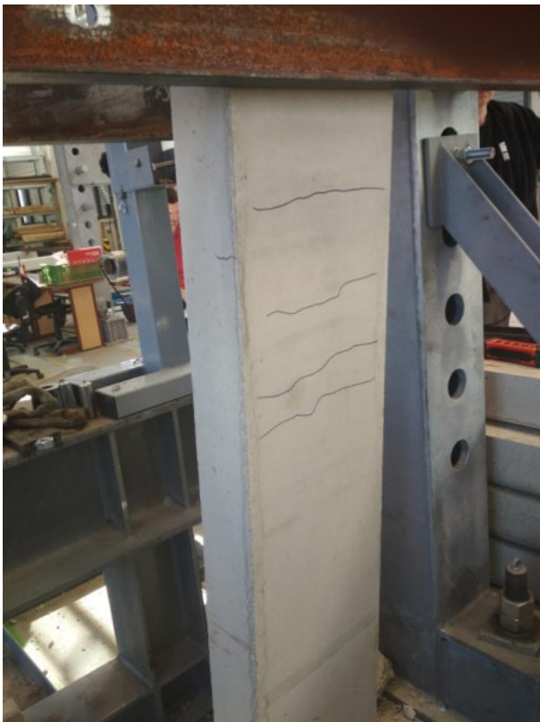
e) P1 – trhliny v polovině rozpětí (experiment)
