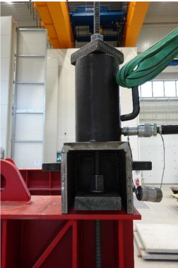
Obr. 6.6 Způsob napínání předpínacích tyčí
