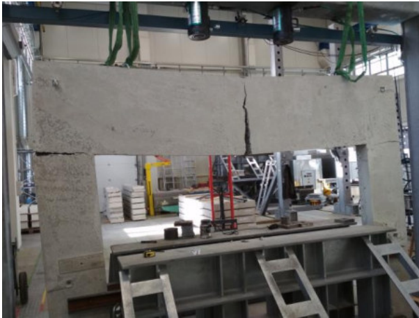
Obr. 6.61 Porušený panel S1.I
