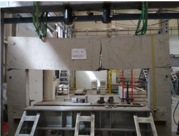
Obr. 6.65 Porušený panel S2.I
