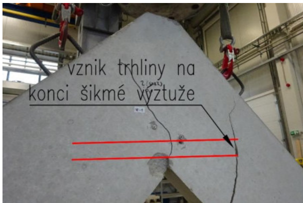
Obr. 7.21 Porušení vzorku SV3 (detail 1) – experiment
