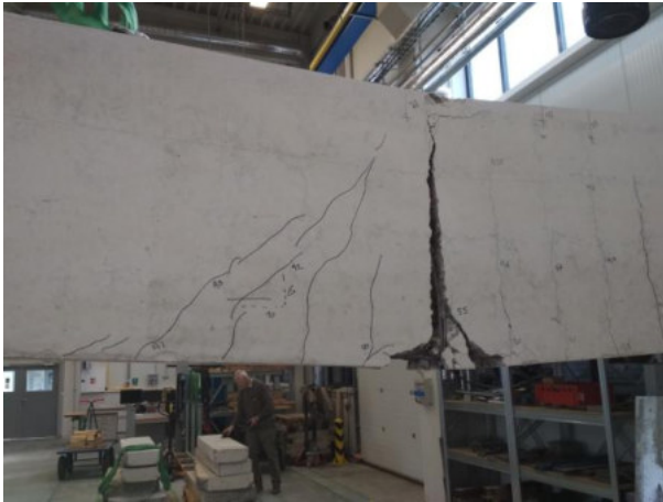
Obr. 6.69 Trhliny v oblasti II – panel S1.II
