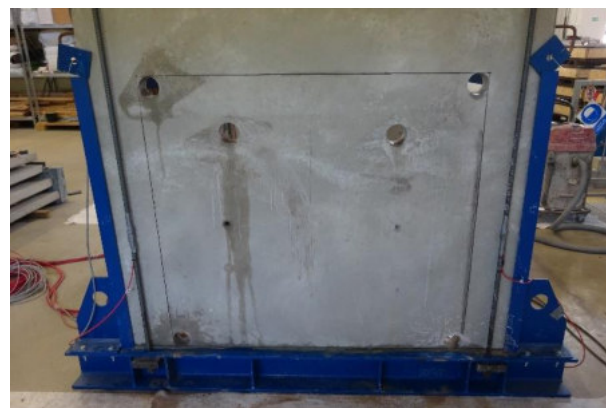
Obr. 6.9 Dokončené jádrové vrty
