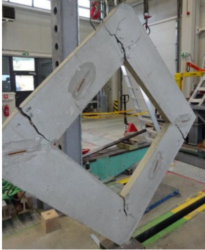
Obr. 7.15 Porušení vzorku SV1 – experiment
