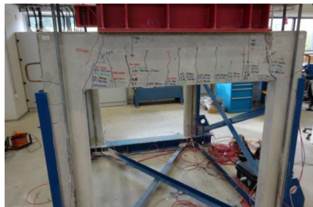
Obr. 6.116 Porušení ZP05.BD – celkový pohled
