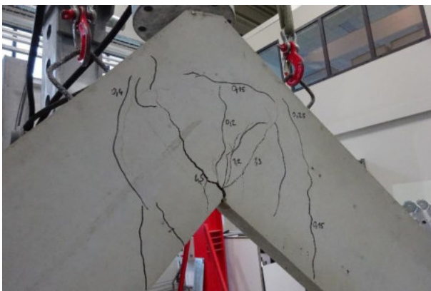
Obr. 7.25 Porušení vzorku SV4 (detail 1) – experiment
