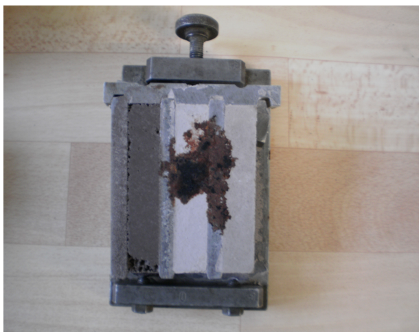
Obr. č. 12 – Forma pro přípravu normových trámečků
