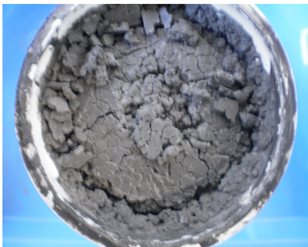
Obr. č. 15 – Neutuhlý a rozpraskaný vzorek č. 2 druhé série
