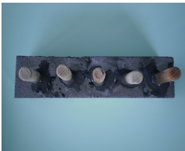
Obr. č. 20 – Naplněný betonový trámeček se zaraženými dřevěnými kolíčky
