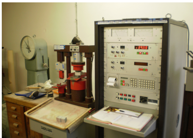
Obr. č. 13 – Sestava zkušební lisu a zaznamenávacího přístroje ve Výzkumném ústavu stavebních hmot v Brně
