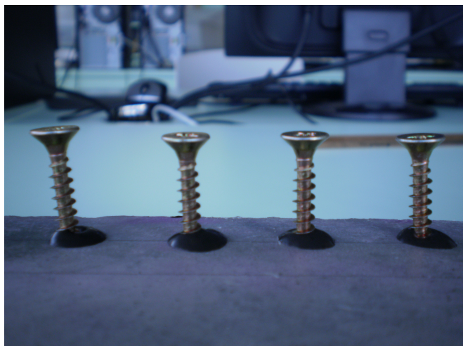
Obr. č. 21 – Naplněná sklovláknobetonová dlaždice se zapuštěnými vruty
