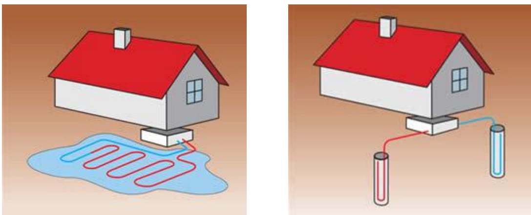
Obrázek 8: Využití systému voda-voda. Zdroj: http://www.teplodomova.com/
