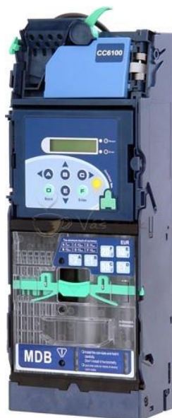
Obrázek 21: Mincovník s funkcí vrácení mincí
