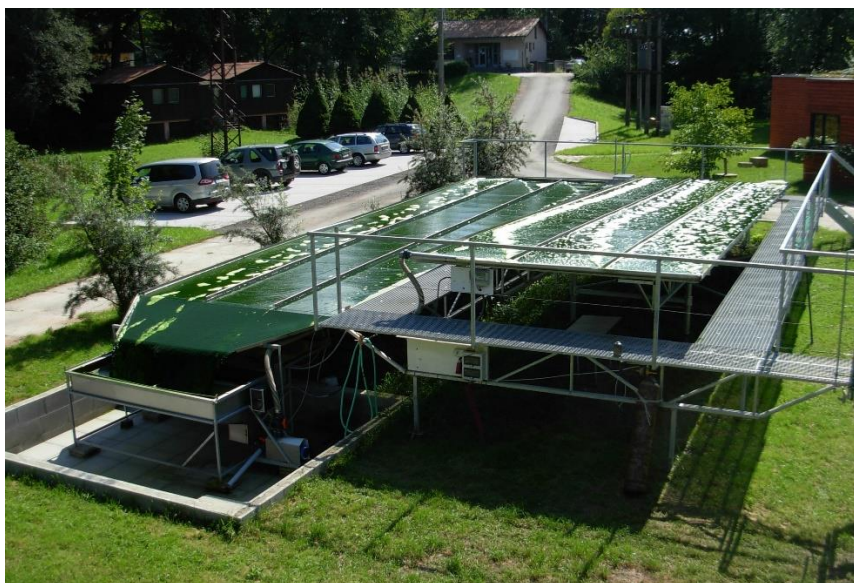
Obr. 3: kaskádovitá jednotka pro venkovní kultivaci řas (www.alga.cz)
