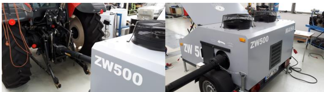
Obrázek 12 Dynamometr MAHA ZW-500 (Zdroj: autor)
