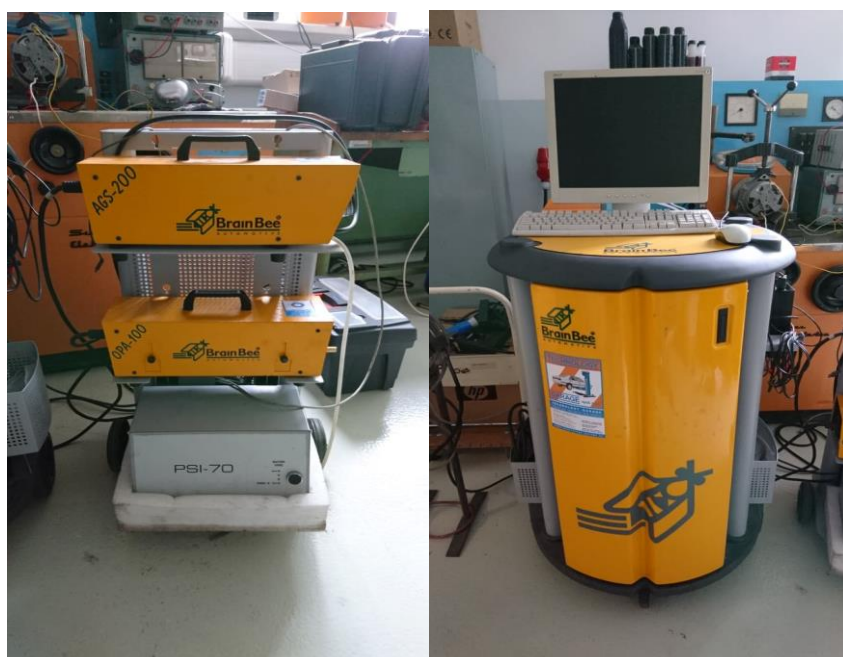
Obrázek 14 Měřicí sestava pro analýzu spalin (Zdroj: autor)
