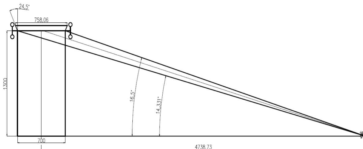
Obr. 26 Causantova konstrukce s návrhem lichoběžníku řízení
