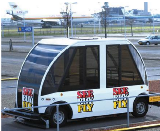
Obr. 12 AGV pro přepravu lidí (Peoplemover) [13]
