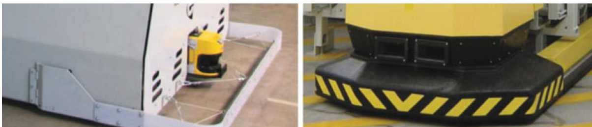
Obr. 20 Příklad bezpečnostních mechanických nárazníků - vlevo plastový, vpravo pěnový [13]
