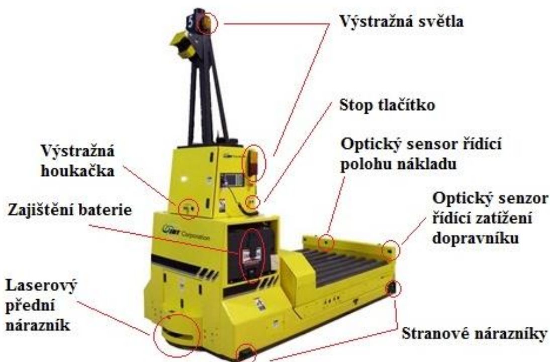
Obr. 19 Příklad bezpečnostních prvků na AGV vozíku [15]
