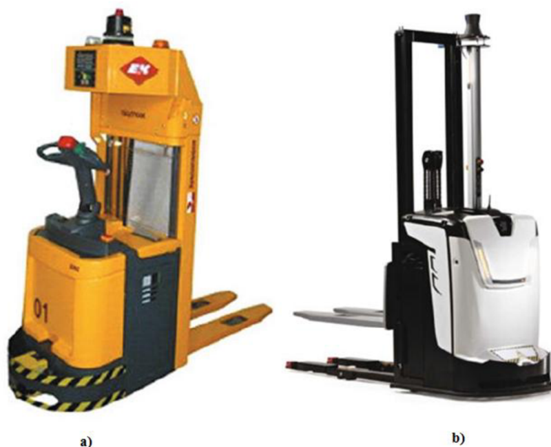
Obr. 7 Příklad vysokozdvížných AGV vozíků – a) vozík upravený pro automatizovanou přepravu materiálu, b) vozík navržený pro automatizovanou přepravu materiálu [13]
