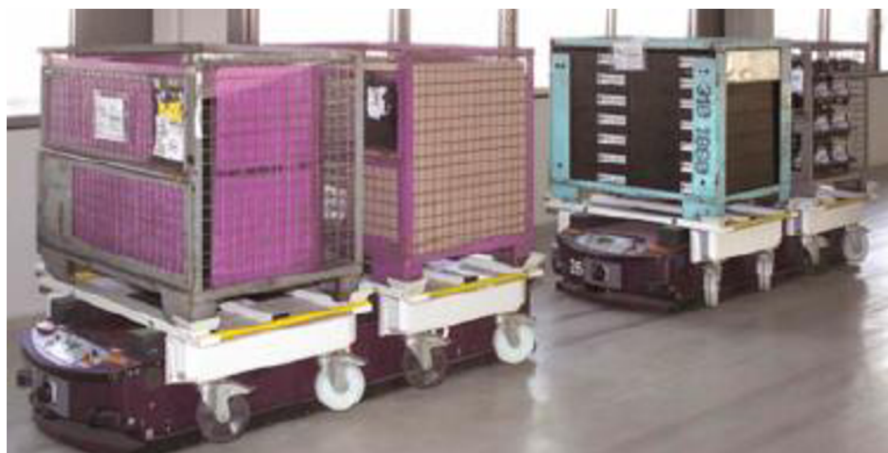
Obr. 10 Podbíhací AGV s nákladem [13]
