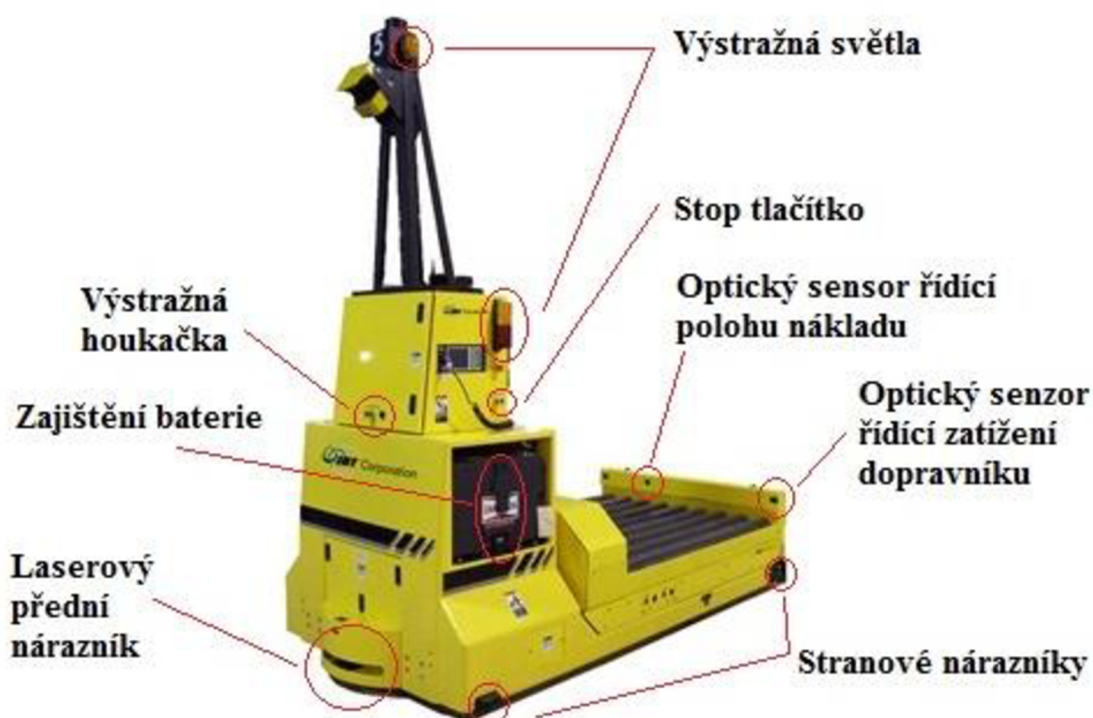
Obr. 19 Příklad bezpečnostních prvků na AGV vozíku [15]
