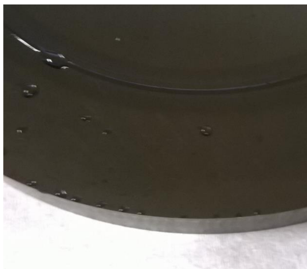
obr. 6-2 Vrstva viskózního maziva na keramickém disku.
