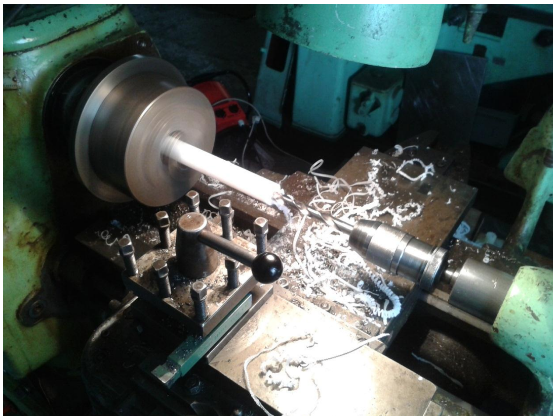
Obr. 4.6 Operace vrtání na soustruhu.
