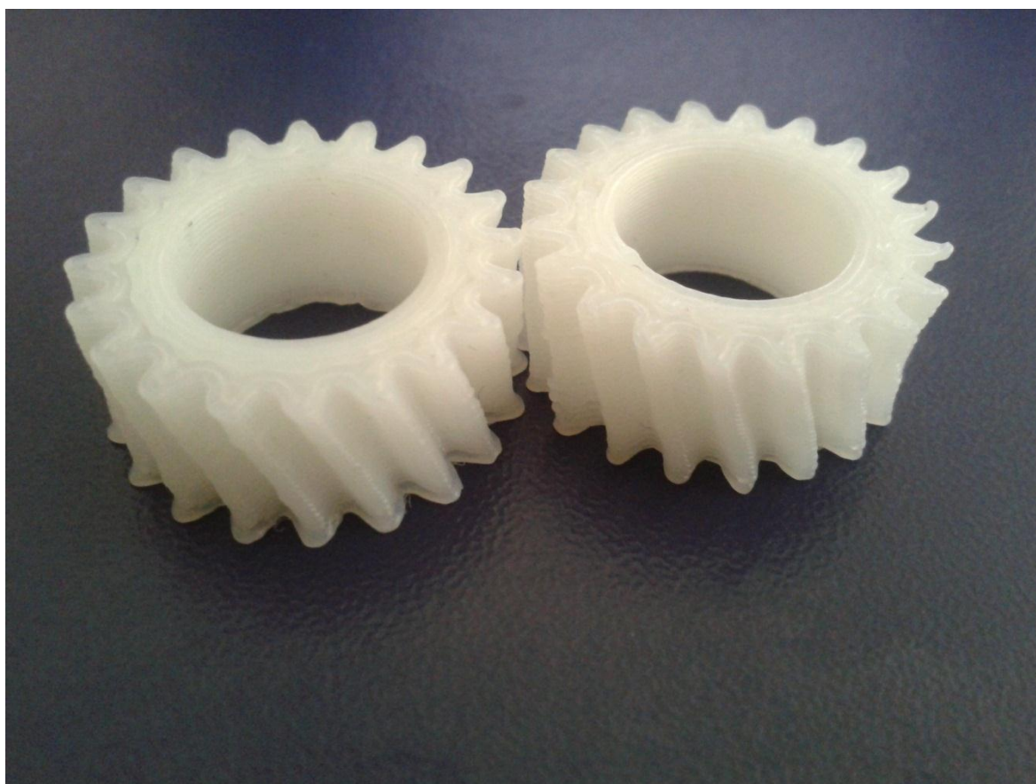
Obr. 4.5 Srovnání modelu se sraženými hranami a bez.
