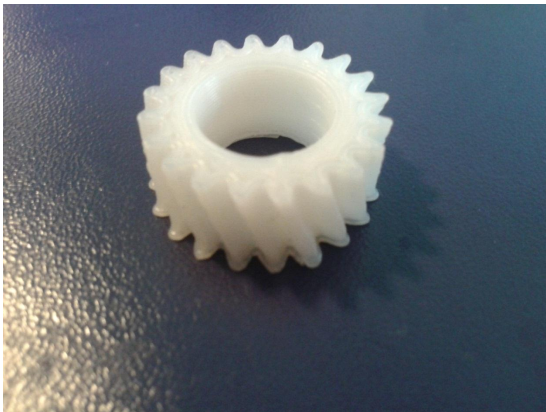
Obr. 4.4 Model tištěný přímo na plochu.
