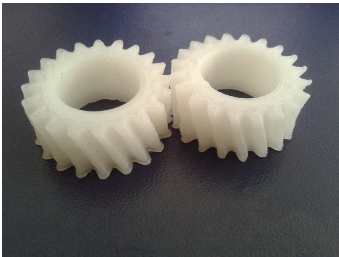
Obr. 4.5 Srovnání modelu se sraženými hranami a bez.
