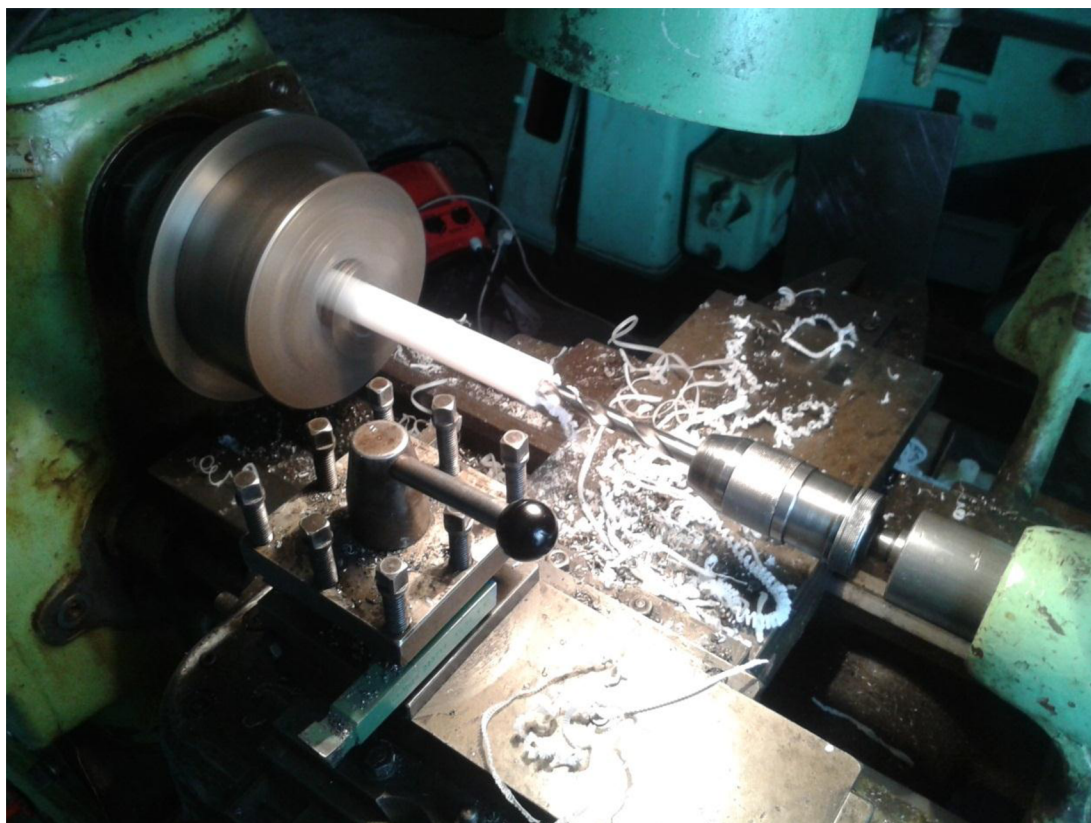
Obr. 4.6 Operace vrtání na soustruhu.
