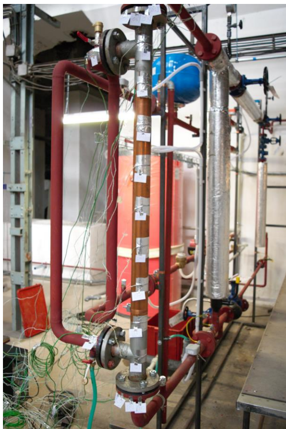
Obr. 3: Umístění teplotních čidel na výměníku
