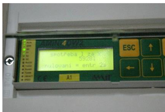
Obr. 5: Zobrazení kumulovaného průtoku systém MaR
