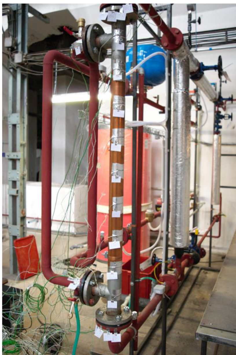
Obr. 3: Umístění teplotních čidel na výměníku
