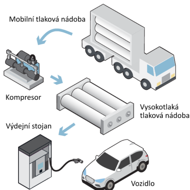
Obr. 9.1 Koncepte vodíkové plnicí stanice s dodávkou tlakového vodíku. Upraveno z [145].
