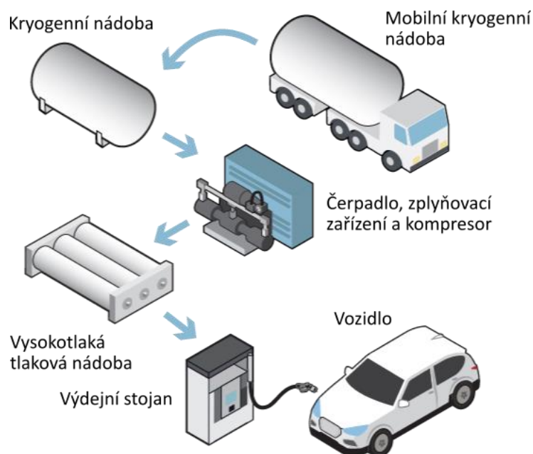
Obr. 9.2 Koncepce vodíkové plnicí stanice s dodávkou kapalného vodíku. Upraveno z [145].
