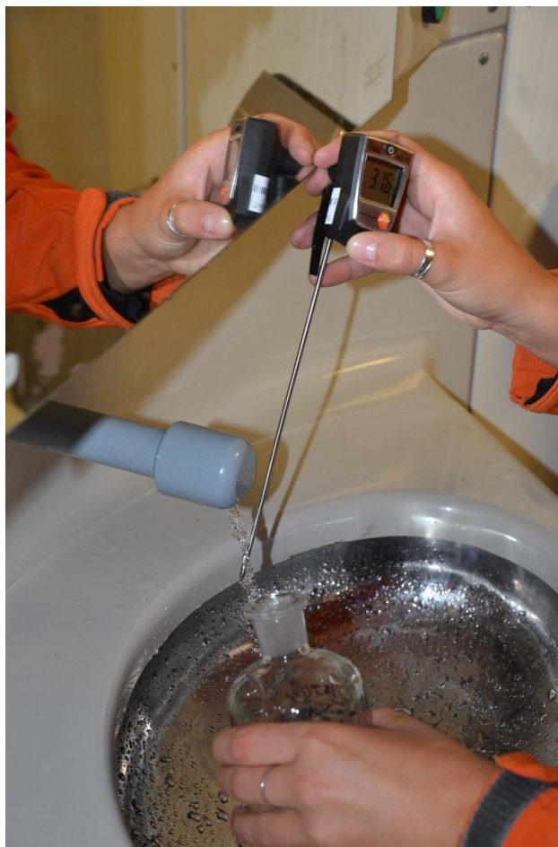
Obr. č. 5 Měření teploty a odběr vody z odtokového raménka ve WC modulu (foto: Škrobalová)
