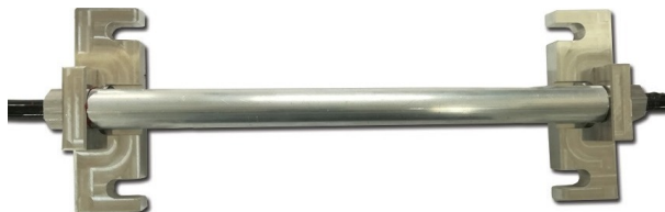
Obr. 4.8: Ťahový FBG senzor [26].
