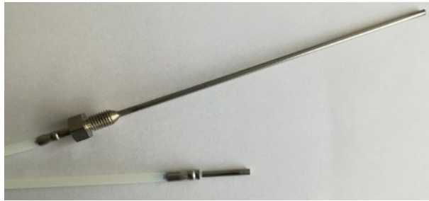
Obr. 4.6: Teplotný FBG senzor v nerezových puzdrách [26].
