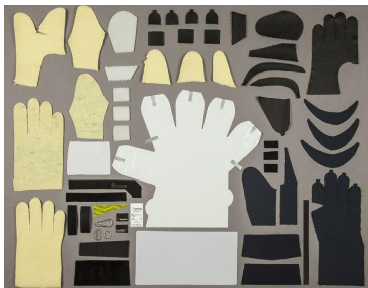
Obrázek 15 Jednotlivé díly speciálních ochranných rukavic [8]
