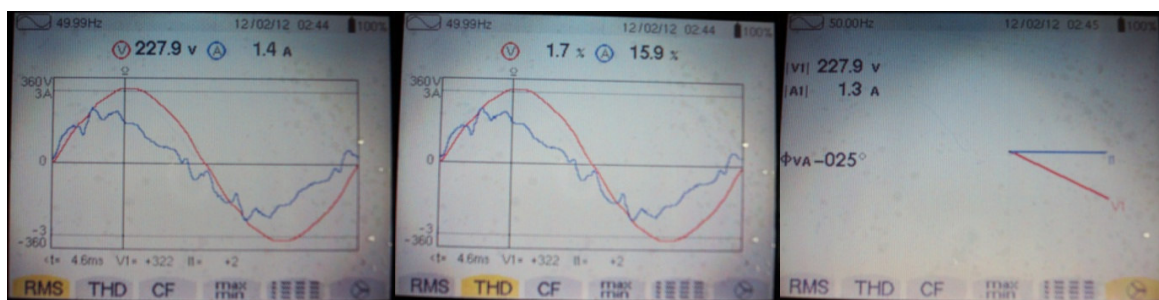
obrázek 27 – Průběh napětí a proudu po připojení kapacity 1500 \eta F
