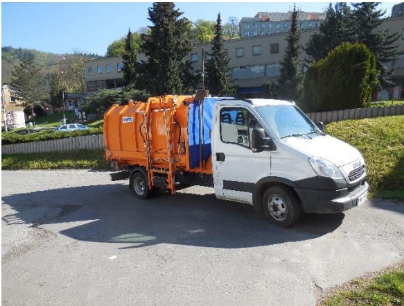
Obrázek 11 IVECO 50C17 s nástavbou na svoz bioodpadu
