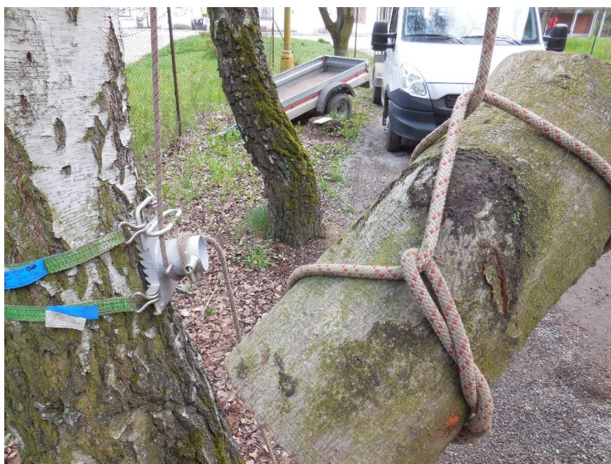
Obrázek 34 Způsob navázání odřezávané části kmene za pomoci tesařského a půllodního uzlu se spouštěním pomocí bubnu
