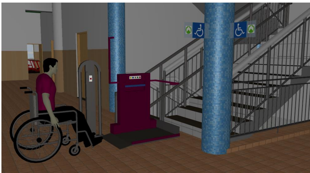
Obr. č. 80 Šikmá schodišťová plošina CPM 300 ve 3NP
