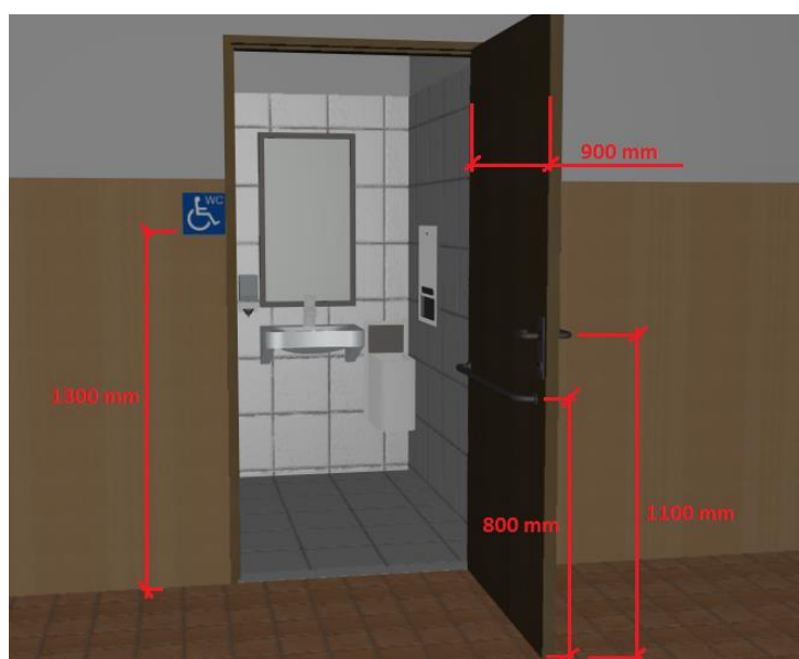
Obr. č. 86 Vstup na bezbariérový záchod 4NP
