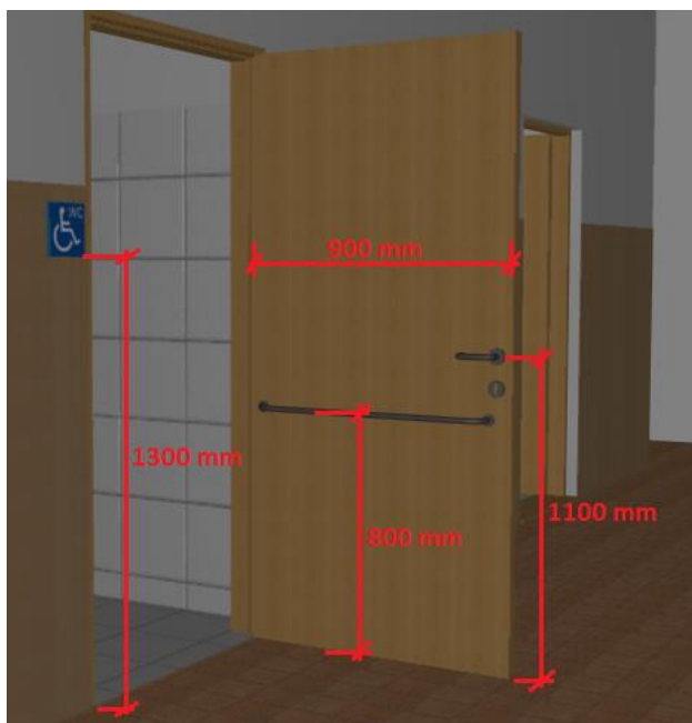
Obr. č. 82 Vstupní dveře na záchod 3NP
