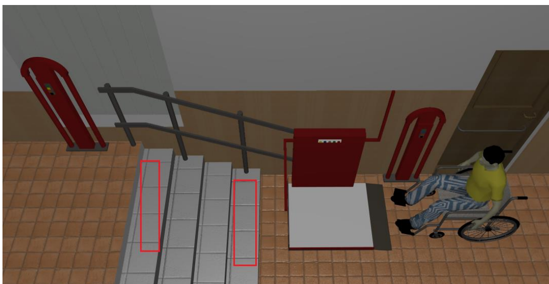
Obr. č. 75 3D pohled na osazení plošiny na schodiště
