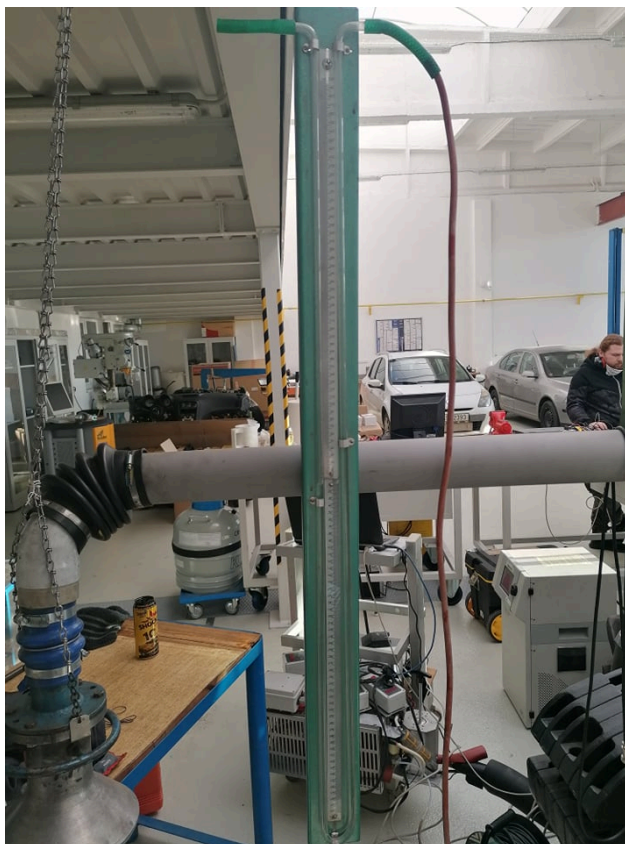
Obrázek 14: Manometr ve tvaru U pro měření tlaku v sání
