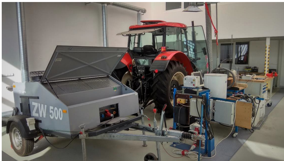
Obrázek 11: Dynamometr MAHA ZW500 připojený k traktoru Zetor
