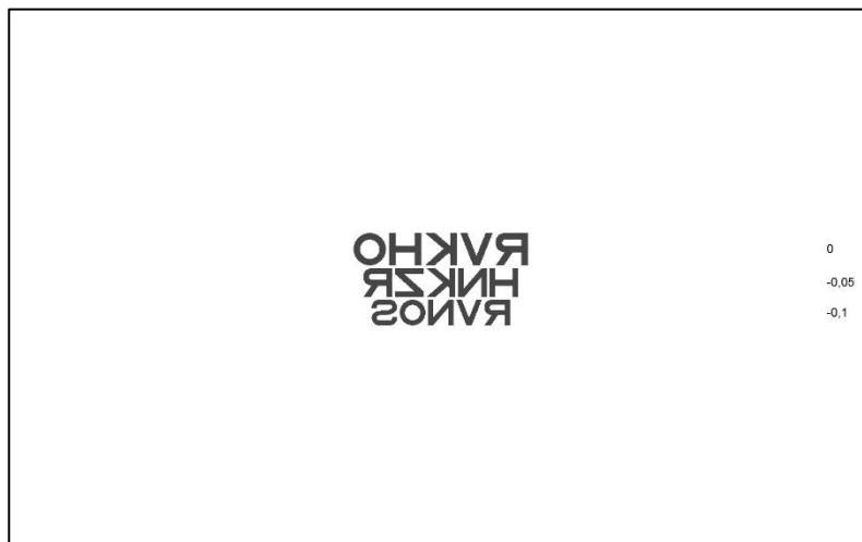
Obr. 16: Příklad prezentovaného stranově převráceného optotypu s kontrastem 90 % a separací 10 % šířky znaku.
