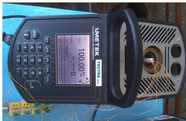
Obrázek 21: Kalibrační pec s vloženými termočlánky
