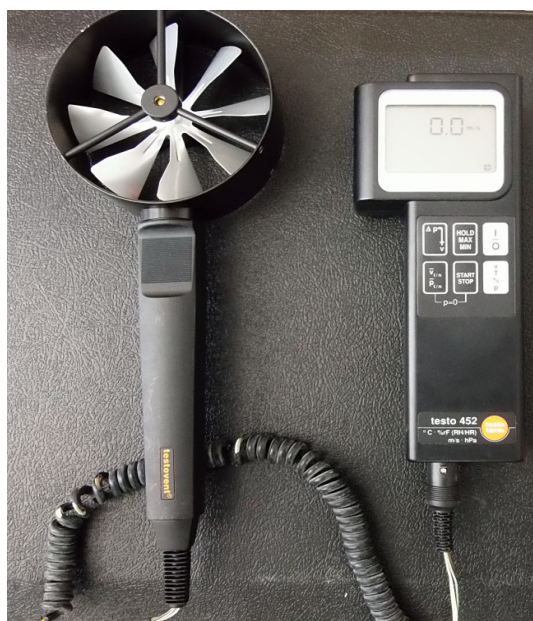
Obrázek 16: Vrtulková sonda Testo 452
