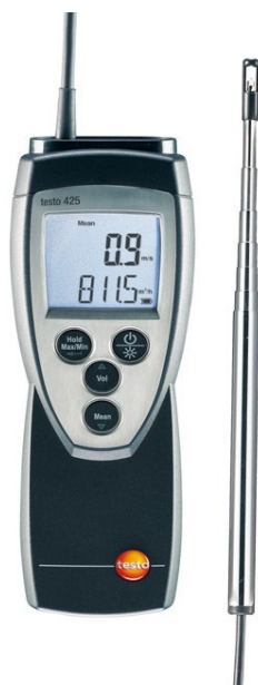
Obrázek 15: Drátková sonda Testo 425 [26]
