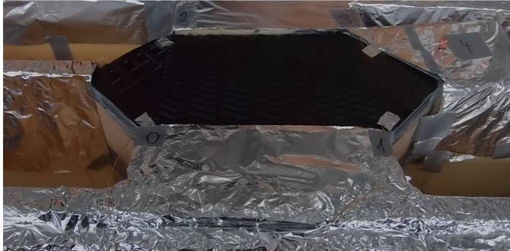
Obrázek 7: Rám rekuperačního výměníku včetně vložených desek a termočlánků
