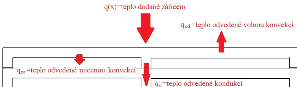
Obrázek 27: Schéma tepelné bilance na desce výměníku
