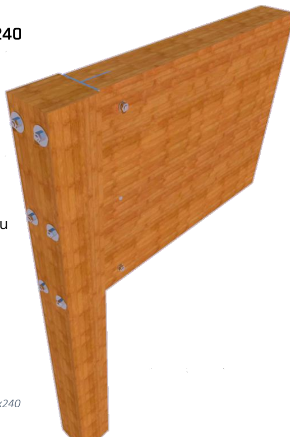
Obrázek 13: Detail přípoje VAZNÍK 200x1100 na PRŮVLAK 240x800
