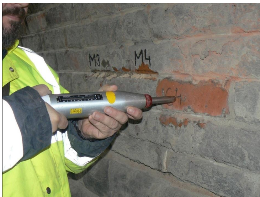
Obrázek 3.3.2-1 Použití Schmidtova tvrdoměru LB pro nedestruktivní stanovení pevnosti cihel [42]
