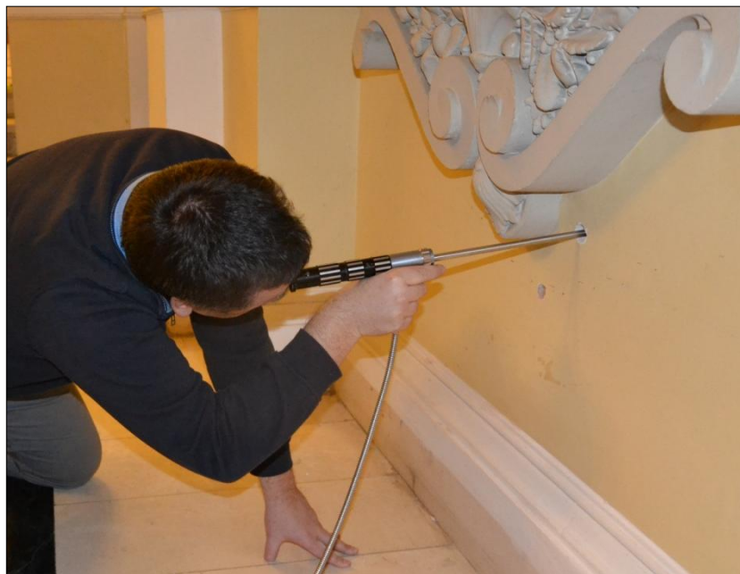
Obrázek 3.3.3-1 Použití endoskopu pro prohlídku dutiny v historickém cihelném zdivu [42]
