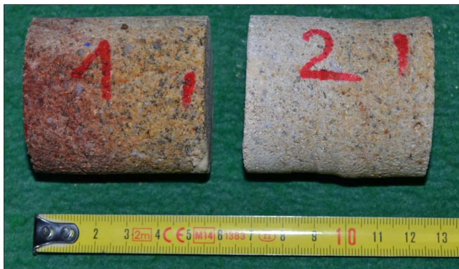
Obrázek 4.5-1 Zkušební tělesa T1 a T2, která byla zhotovena z jádrového vývrtu pískovcového klenbového pilíře [42]
