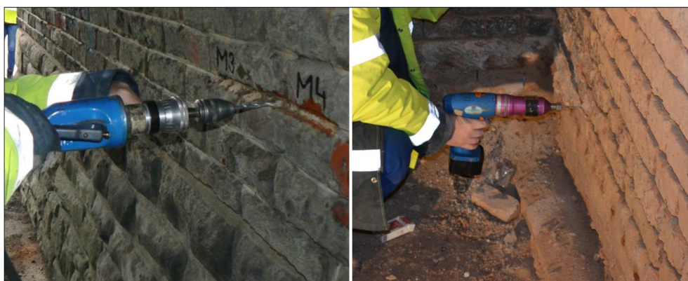
Obrázek 3.3.2-3 Příklad stanovení pevnosti malty cihelného zdiva pomocí Kučerovy vrtačky, vlevo ruční, vpravo elektrické [42]
