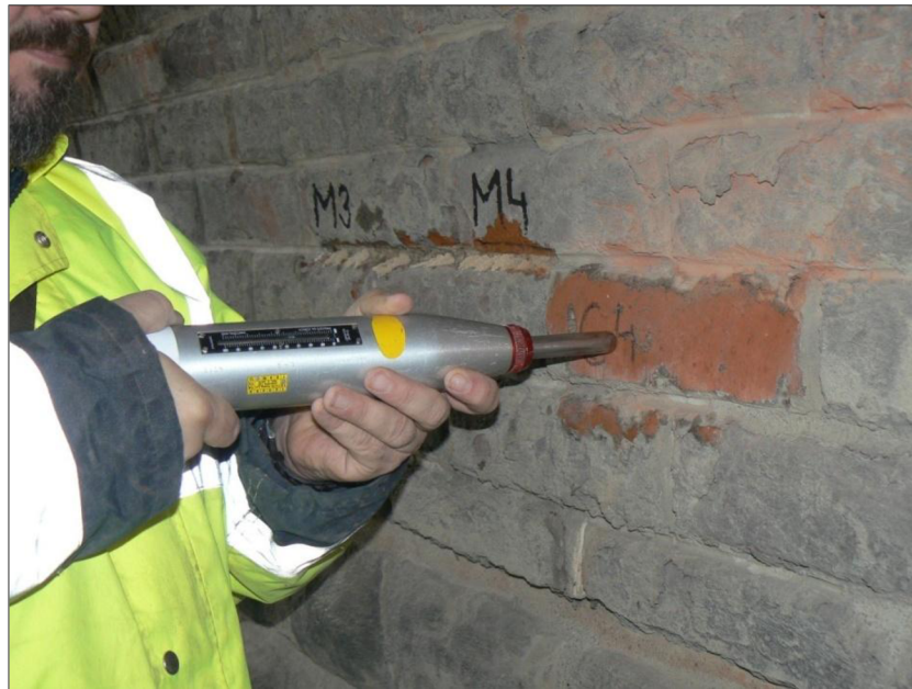
Obrázek 3.3.2-1 Použití Schmidtova tvrdoměru LB pro nedestruktivní stanovení pevnosti cihel [42]
