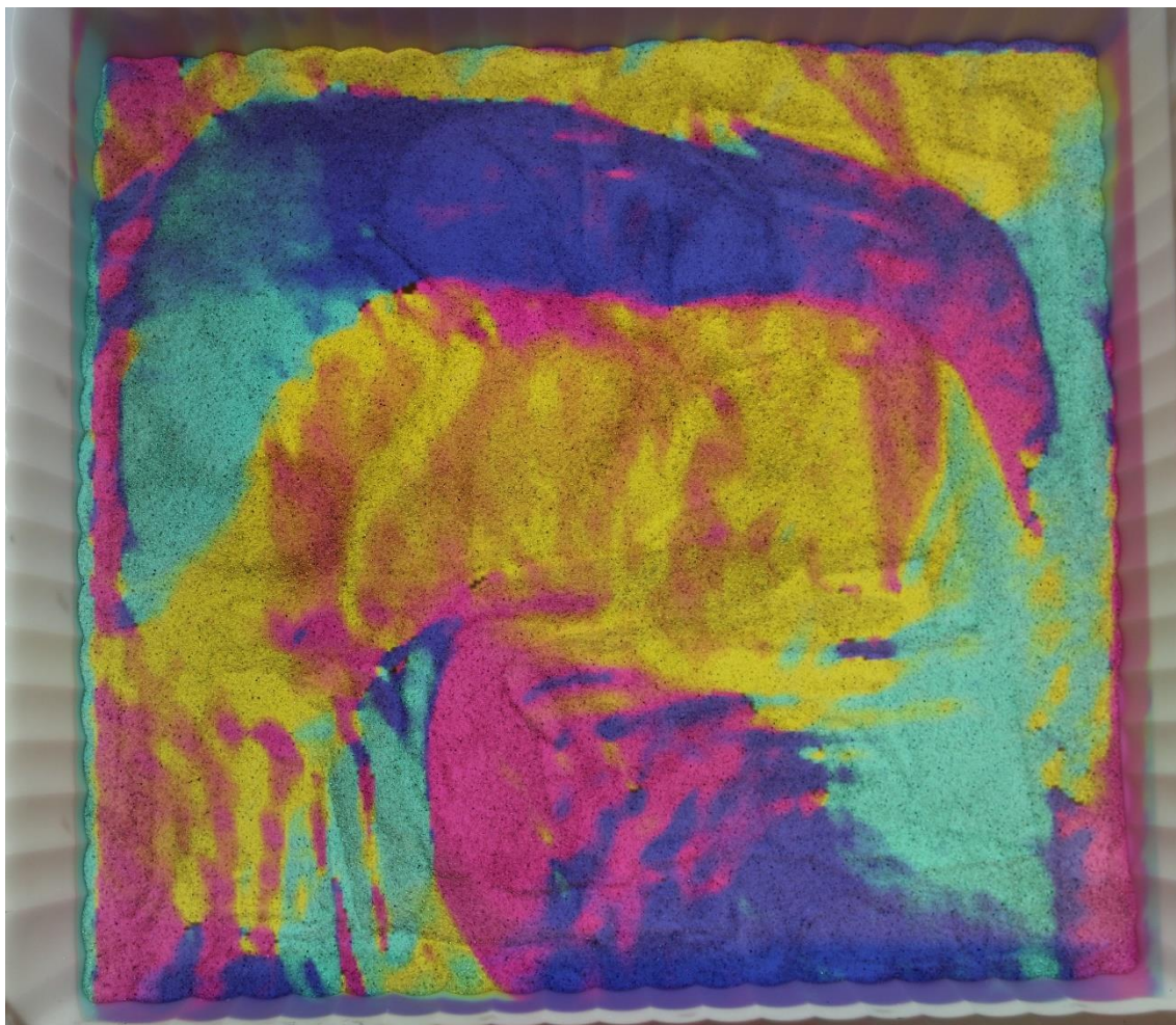
Obrázok 5.5: Vizualizácia expozície terénu voči svetovým stranám – pohľad zhora, fialové plochy smerujú napravo, svetlomodré naľavo, tmavomodré hore a žlté dole
