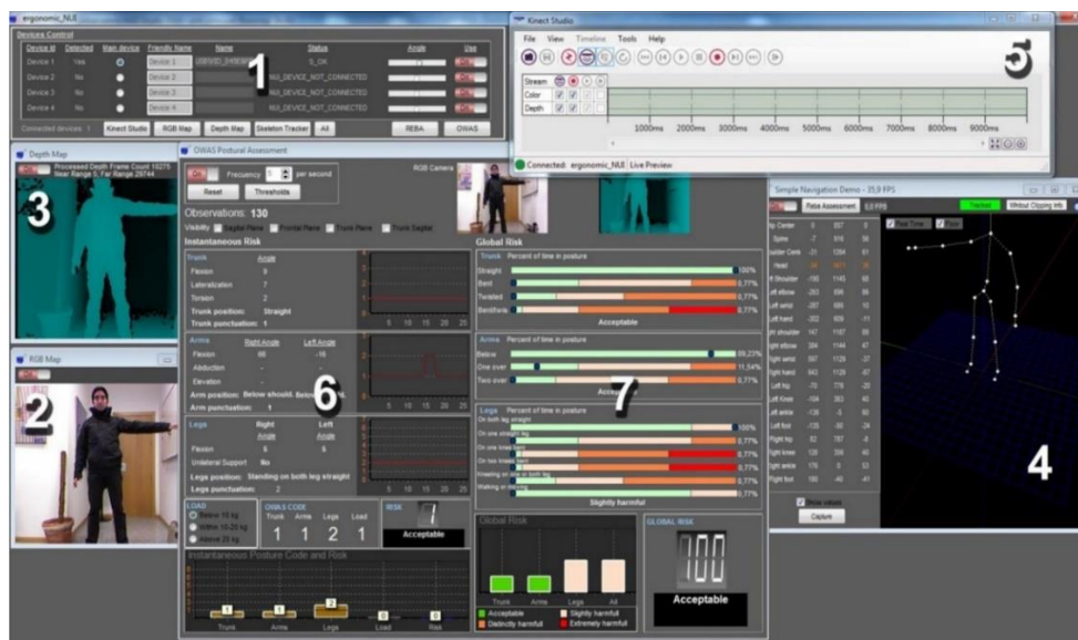
Obrázok 3.3: Softvér vyvinutý na spracovávanie údajov z Kinectu. 1: Jednotka riadenia snímača. 2: RGB obraz z kamery. 3: Hĺbková mapa. 4: Údaje o skelete. 5: Záznamová jednotka. 6: Posúdenie postoja metódou OWAS. 7: Výpočet celkového zaťaženia v jednotlivých polohách počas práce [9].
