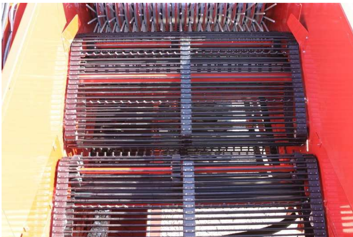
Obr.18 – Oddělovač plodů sklízeče Cosmo Evolutio 6000 (firma Pomac)
