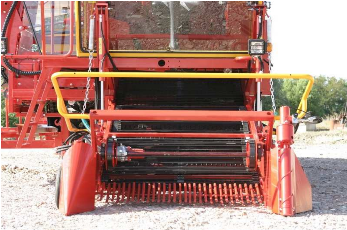
Obr.19 – Sběrač sklízeče Cosmo Evolutio 6000 (firma Pomac)
