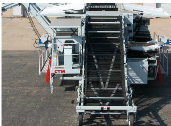
Obr.14 – Sběrač sklízecce Commander 3240 (firma CTM)
